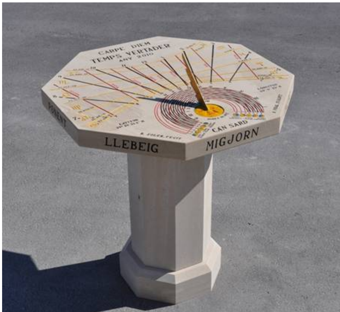
CUADRANTE LUNAR, DONDE SE HA COMPROBADO EL MÉTODO EXPUESTO, COMBINADO CON EL SOLAR DE HORAS VERDADERAS DE BASE PARA SU CÁLCULO, Y TEMPORARIAS (AJENAS AL CÁLCULO).
