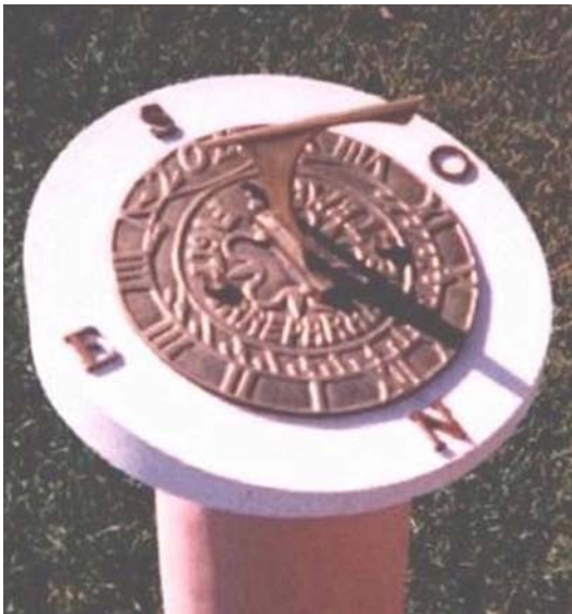
Reloj horizontal sobre cuña de piedra para adaptarlo a la latitud deseada.
