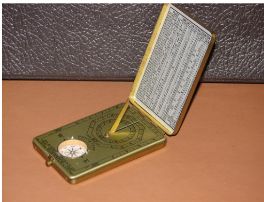
Horizontal de Boy scout, adaptable a varias latitudes.
