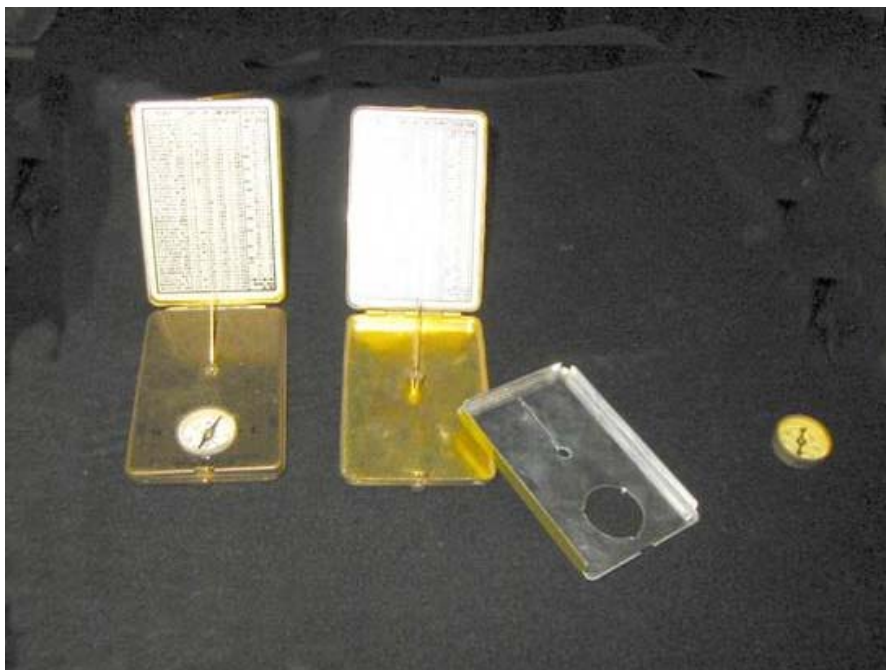
Aquí se pueden ver las distintas piezas del reloj: cubierta con las tablas, columna con un pasador donde está colocado el gnomon, chapa con la superficie del reloj y brújula.
