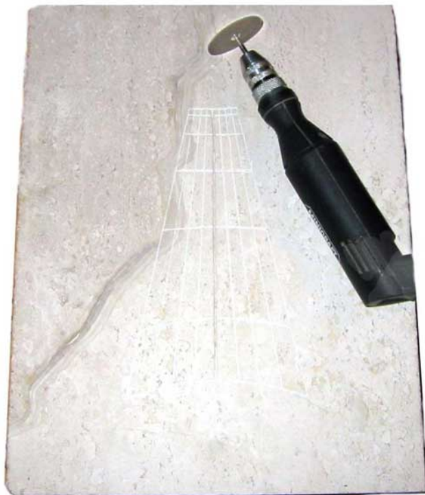
Con este disco en el mini taladro realicé la fisura.
