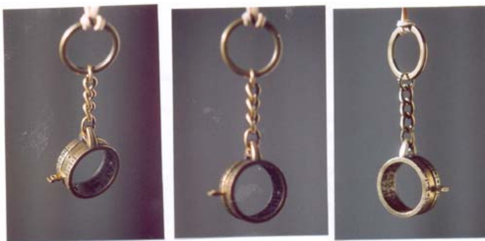
RÉPLICA DE VILLA ALCOR DEL CUADRANTE ÁNULO . H . S . THON DE 1721 CON ESCALA DE CALENDARIO PARA LATITUD DE 45° Y ESCALA HORARIA (BURDA) EQUINOCCIAL PARA MEDIODÍAS FIJOS
