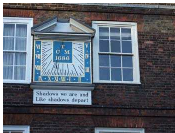
Un autre cadran vertical déclinant situé dans le Temple Bar de Londres. On le retrouve sur le mur de Pump Court . Il est daté (1686) et signé (?) par des initiales (T.C.M.). La devise: « Nous sommes des ombres et comme elles nous disparaissions». (Register 2000: #1295 Londres). Les chiffres sont romains. Les lignes indiquent les heures (V-XII-V), les demies et les quarts d'heures.
