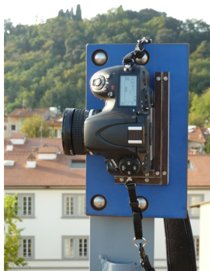
Fig. 3 - Macchina fotografica digitale fissata sulla stazione e pronta per le riprese.
